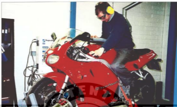
Un panneau de contrôle portable permet à l'opérateur de programmer les essais et de contrôler les résultats tout en restant assis sur la moto.
