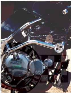
Le moteur de la Triumph Tiger est relié à une boîte de vitesses Speed Triple. La culasse à barières et circulation, abaissée, est équipée d'arbres à cames Speed Triple.
